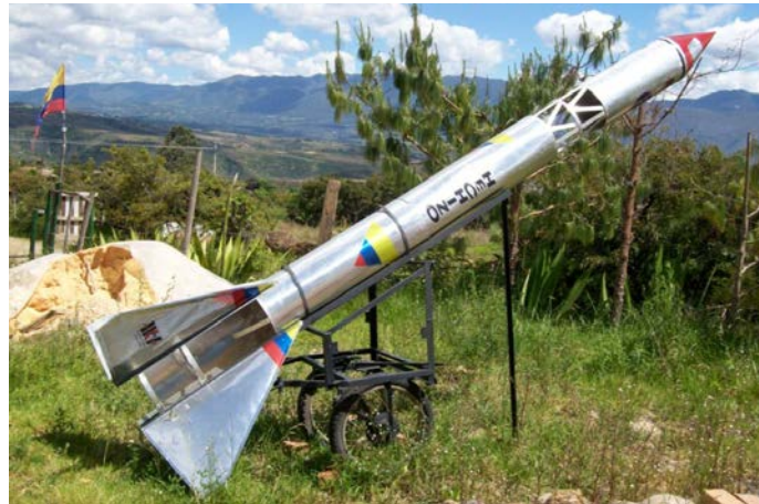
Ilustración 9 Cohete de combustible liquido HECHIZO
